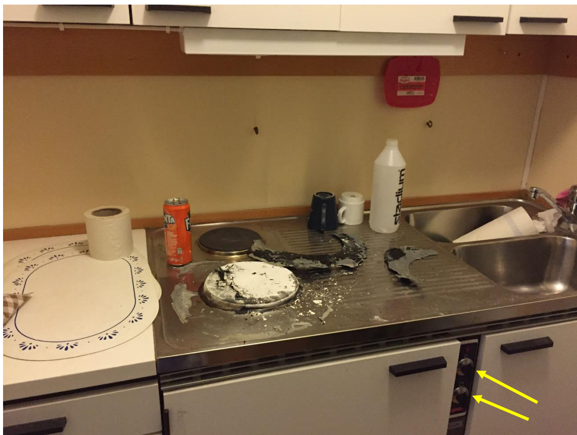
Bild 3. Sotskadad spisplatta och kolade rester från brandtillbudet synliga. Reglagen till spisplattorna som sitter till höger om kylskåpet markerade.
