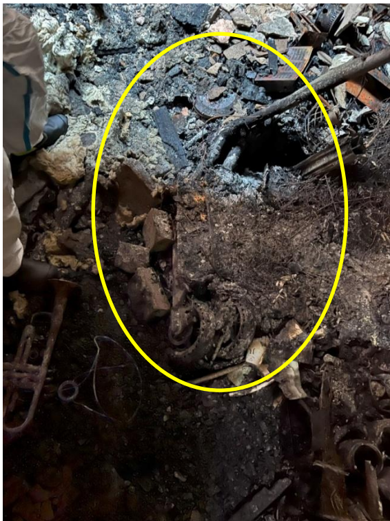
Figur 9 Elsparkcykel vars batteri troligt orsakade branden hittades nedanför trappan till plan 0 markerad med gul ring.
