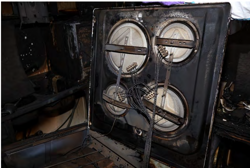
Figur 6 Undersidan av spisplattorna vilka inte påvisar större sotning (Foto: Polisen)
