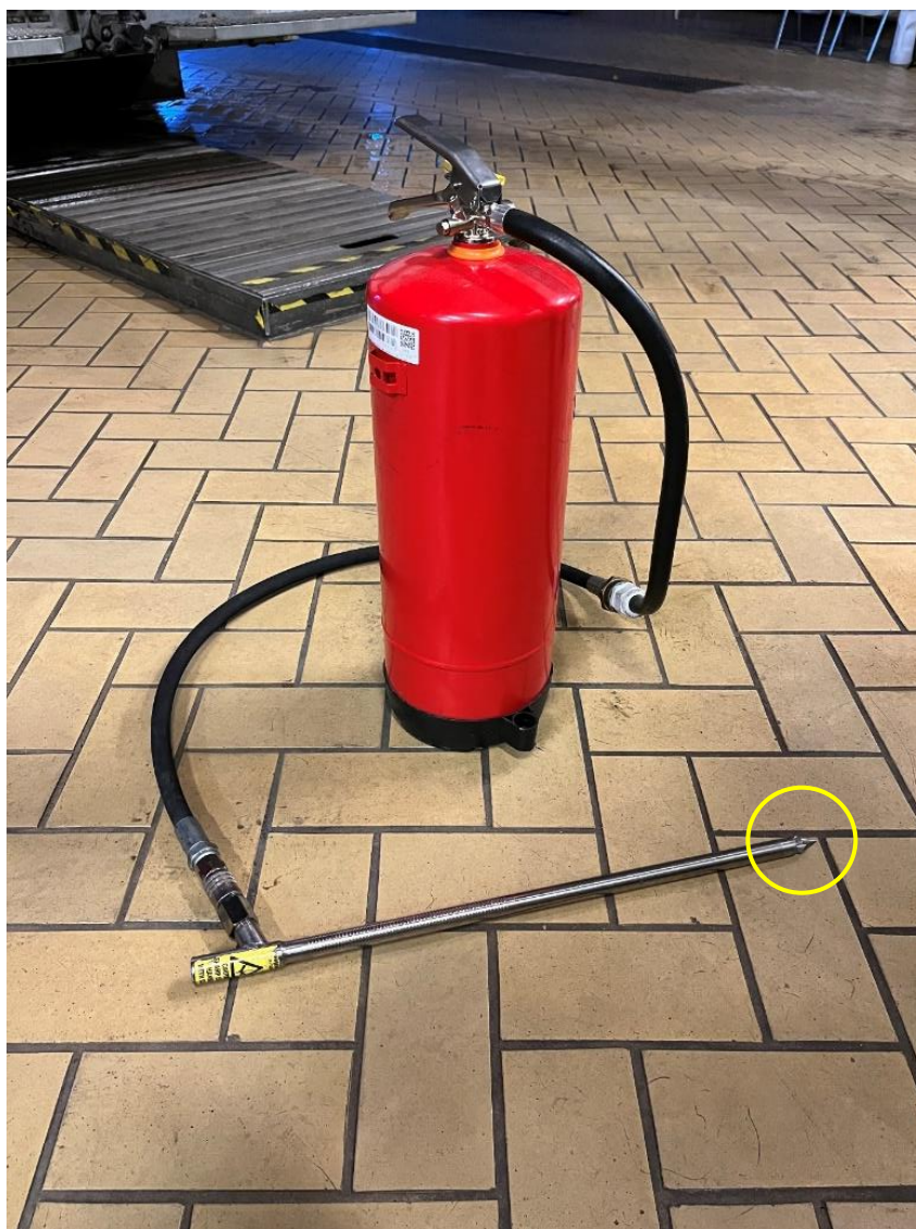
Figur 9. Pulversläckare med påkopplat pulverspätt. Munstycket för pulvrets utlopp/påföring markerad. Bild tagen av utredaren på Kista brandstation.
