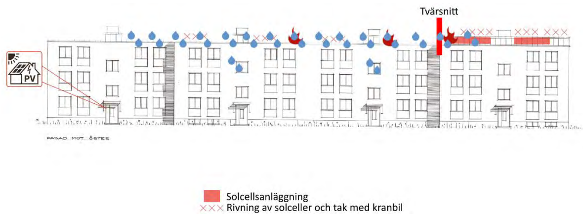
Figur 20. Brandens förlopp. Byggnadens östra fasad
