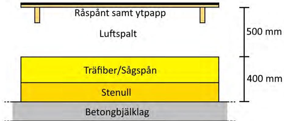
Figur 31. Illustration, genomskärning av takets olika skikt (Ej skalenlig)
