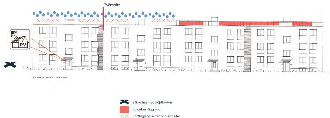
Figur 14. Räddningsinsatsen avslutas. Byggnadens östra fasad.
