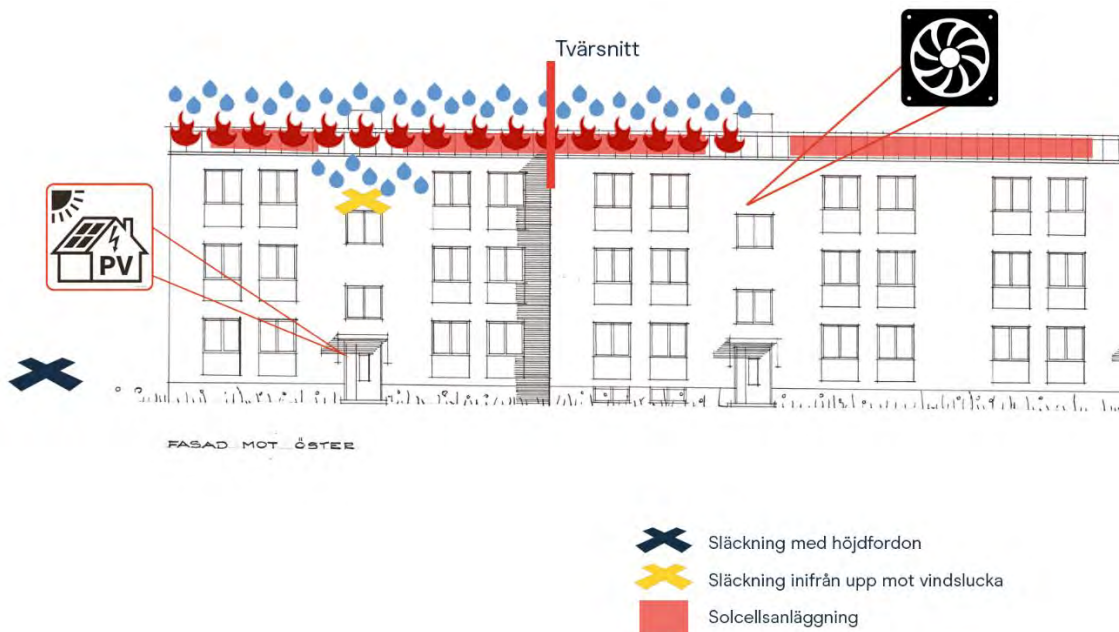
Figur 13. Brandens förlopp. Byggnadens östra fasad. Fläktens placering i trapphus C är markerad.
