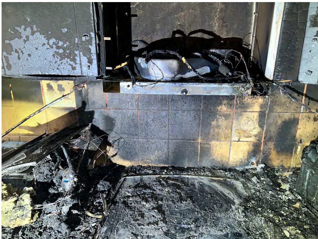
Figur 4 Spisen och fläktkåpan. Till vänster ligger delar av spisfläkten samt en brandskadad vitvara (troligen kaffekokare)
