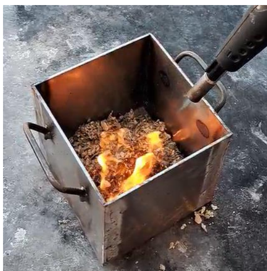
Figur 22. Test med direkt låga, antändes efter 1,5 s
