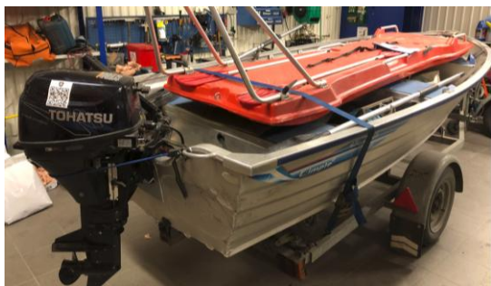
Figur 3 Trailer båt Föllinge, Kimple 430 Catch, aluminium, båtmotor 9,8hk
