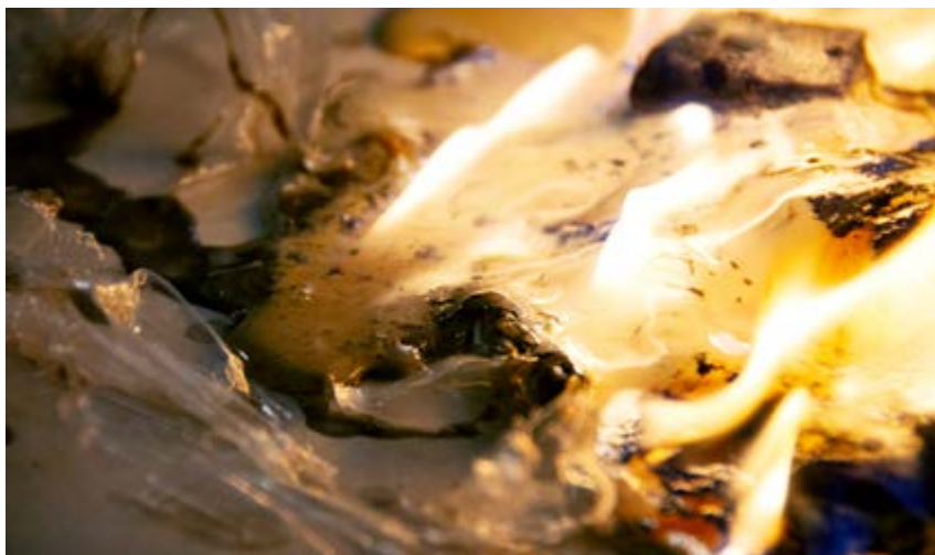
Termoplaster kan smälta, börja brinna och rinna iväg långa sträckor och därigenom bidra till spridning av brand. Foto: Stefan Svensson.
