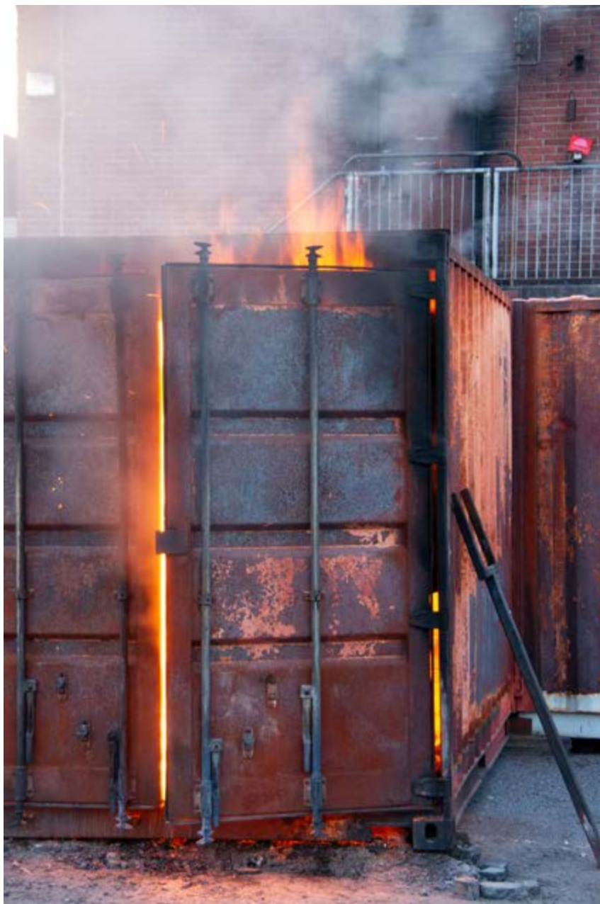
I en stålcontainer, som ofta används vid räddningstjänstens övningar, sprider sig brand på andra sätt än i ett riktigt möblerat rum, eftersom väggarnas och takets värmeupptagningsförmåga är annorlunda. Foto: Stefan Svensson.
