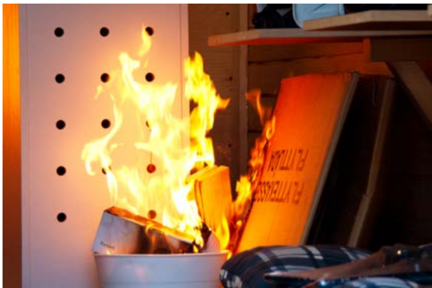
Initialbranden värmer upp det bränsle som ännu inte brinner, så att flamspridning i bränslet kan ske. Foto: Stefan Svensson.
