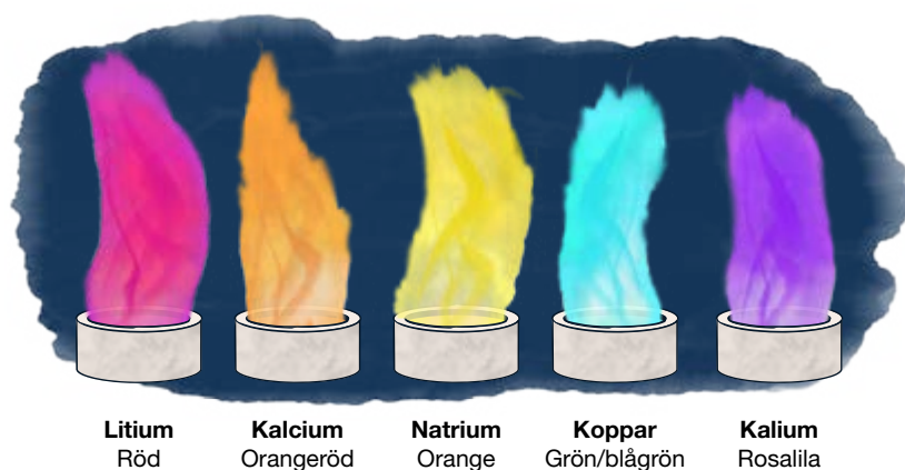
Figur 50. Olika ämnen kan ge olika färg på flammor
