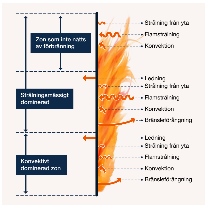
Figur 47. Flamspridning över en vägg
