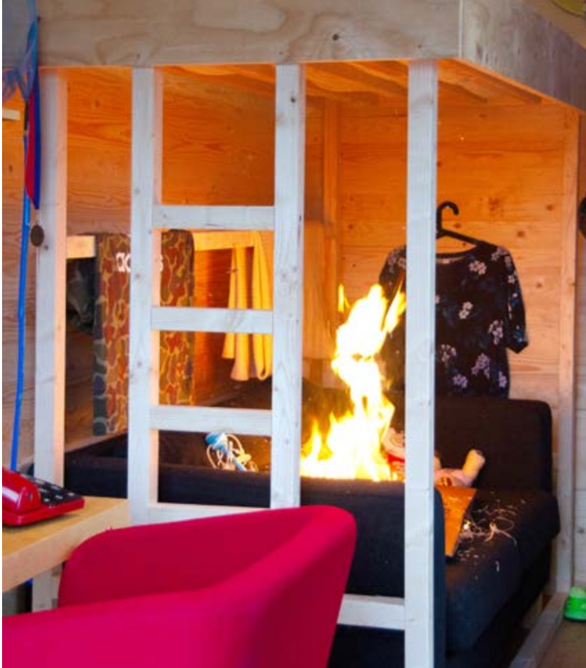
En bränslekontrollerad brand är en brand vars utveckling i huvudsak styrs och påverkas av bränslets egenskaper. Foto: Stefan Svensson.
