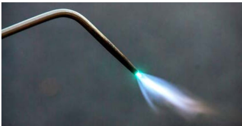
I en svetslåga vill man ha fullständig förbränning, för att temperaturen ska bli så hög som möjligt. Foto: Stefan Svensson.
