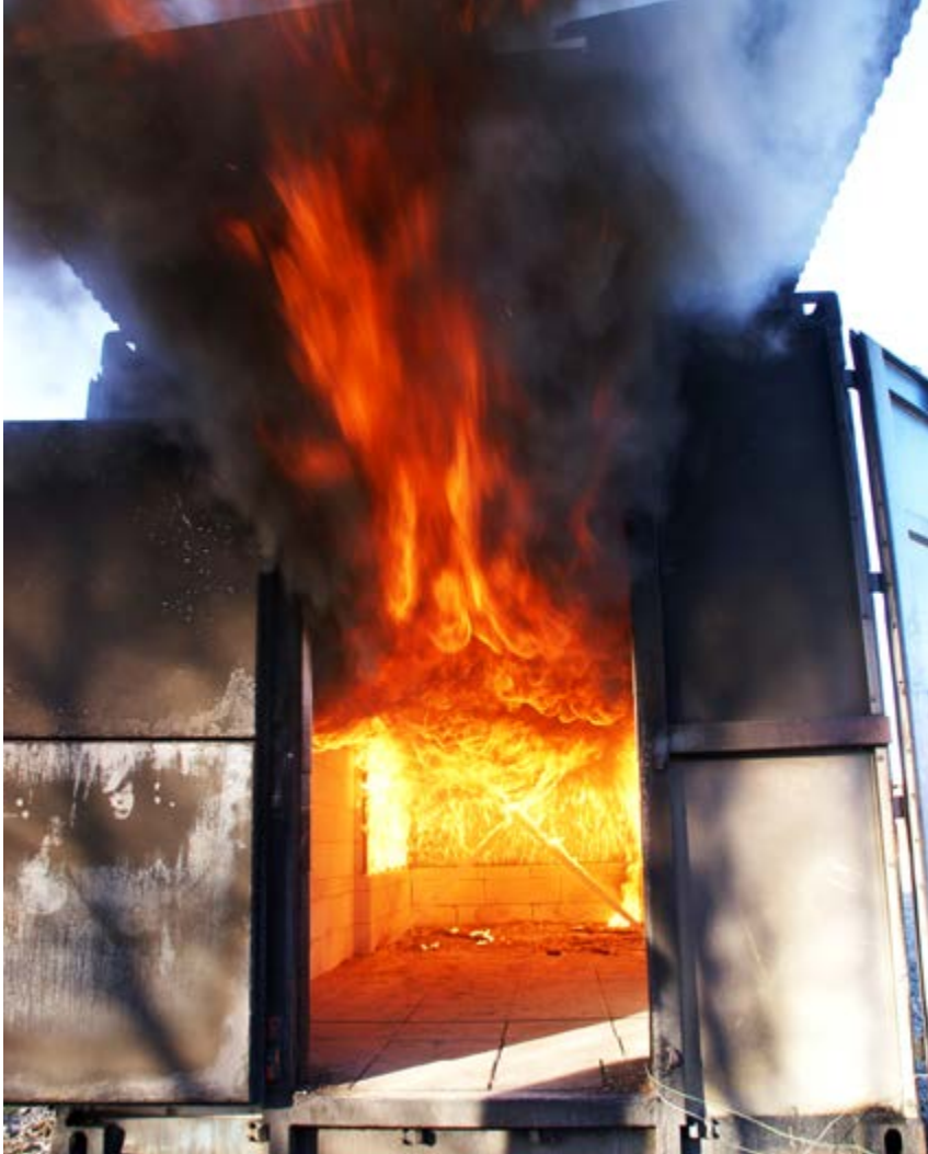
Brandens avsvältningsfas bygger på att branden utvecklas och sprids helt utan mänsklig inverkan men att branden inte sprider sig utanför det initiala brandrummet. Foto: Stefan Svensson.
