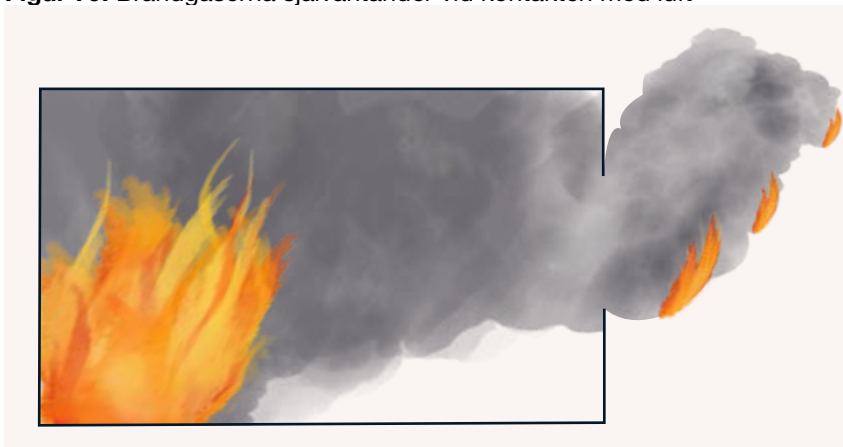
Figur 79. Brandgaserna självantänder vid kontakten med luft
