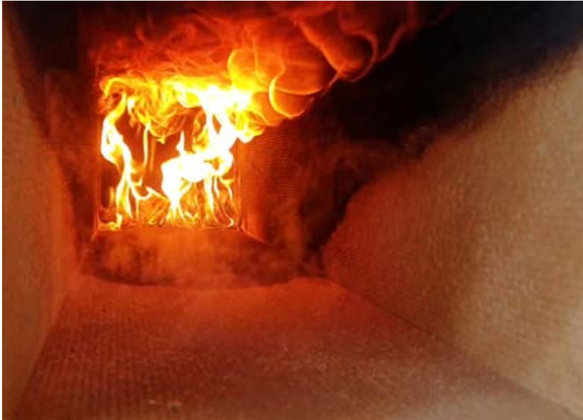
Värmestrålningen från flammorna gör att ytorna på golvet och väggarna pyrolyserar. Foto: Stefan Svensson.
