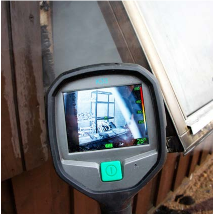
Med hjälp av en IR-kamera kan vi upptäcka och identifiera till exempel olika föremål genom brandgaser. Foto: Stefan Svensson.
