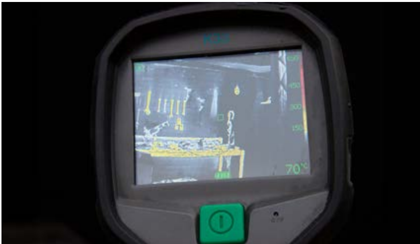
Olika material kan ha olika emissivitet och uppfattas därför olika i till exempel en värmekamera. Foto: Stefan Svensson.
