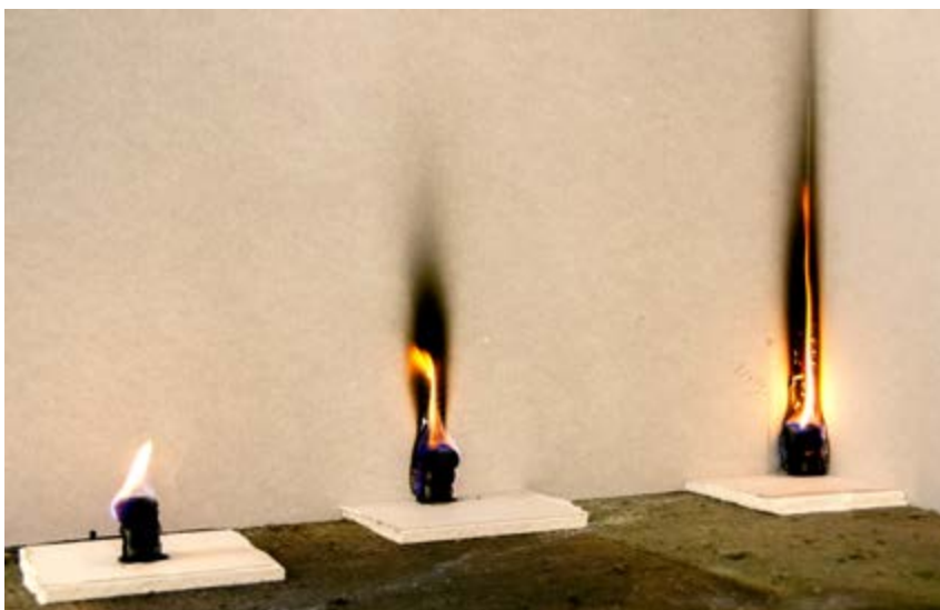
Flamnor i ett hörn blir högre än mitt på en vägg eller mitt i ett rum. Foto: Stefan Svensson.
