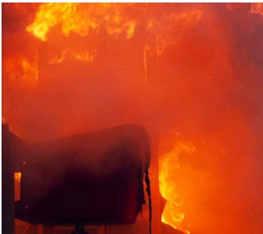
En ventilationskontrollerad brand är en brand vars utveckling i huvudsak styrs och påverkas av tillgången till syre. Foto: Stefan Svensson.
