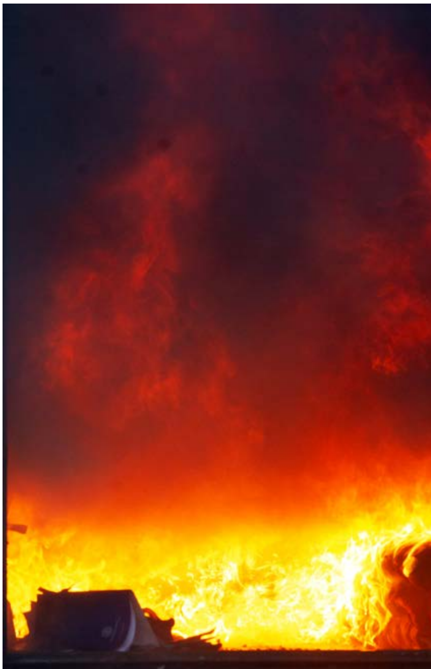
En övertändning är ett övergångsskede från att branden är bränslekontrollerad till att branden blir ventilationskontrollerad. Foto: Stefan Svensson.
