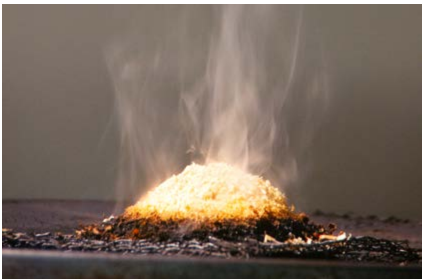
Vid pyrolys bryts fasta ämnen ner och bildar brännbara gaser. Foto: Stefan Svensson.
