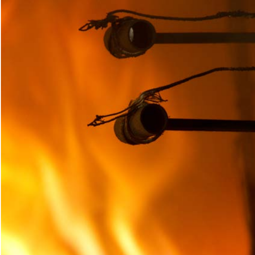
Forskning om brand är ofta experimentell. Bilden visar två termoelement (för att mäta temperatur) monterade på varsin så kallad bi-directional probe (för att mäta och beräkna gasers hastighet). Foto: Stefan Svensson.
