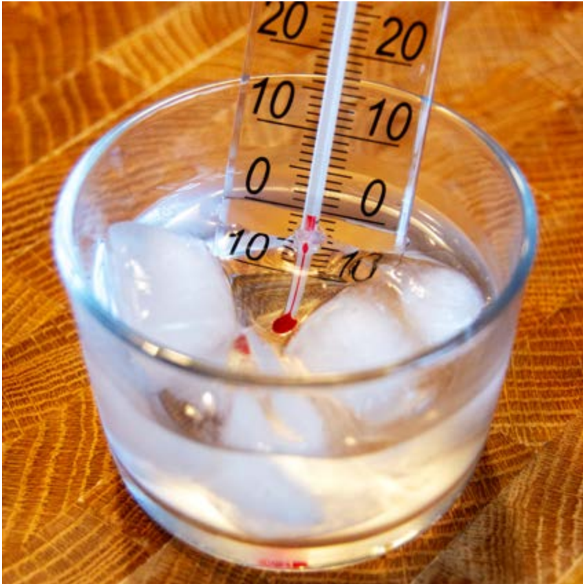
Den temperatur då ett fast material smälter kallas smältpunkt, och den värmeenergi som behövs för att det fasta materialet ska smälta kallas smältvärme. Foto: Stefan Svensson.
