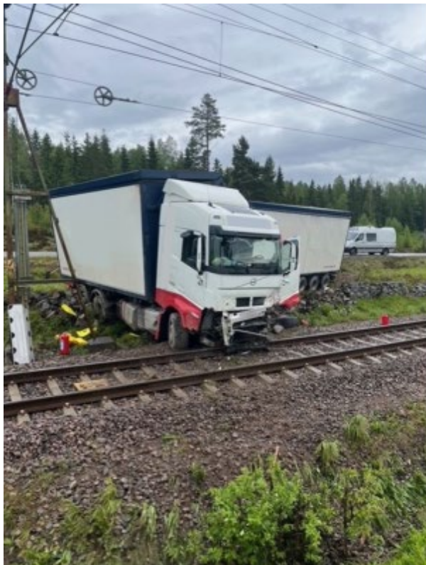
Lastbilens slutposition mot rälen. Rälen böjs.
