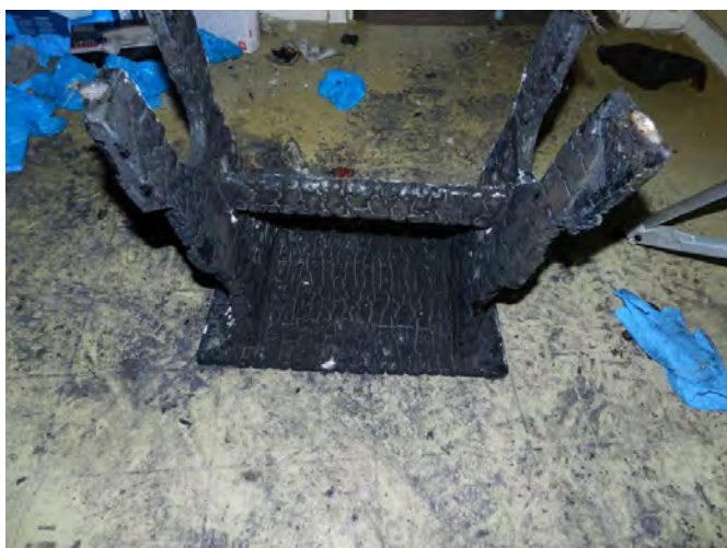
Pallen har kraftiga brandskador på undersida
