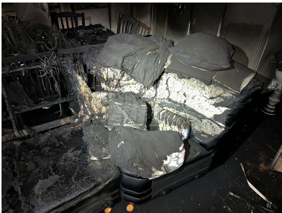
Figur 11 Kläder, lakan, ■■■ mm. i anslutning till soffans ena sida. Motsatt sida från brandstarten.
