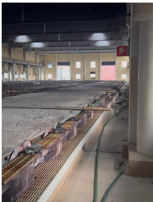
Figur 22: Bassänger med elektrolyt (svavelsyra) inne i elektrolytverket. Till vänster ses upphissade kopparanoder och till höger ses nedsänkta anoder under duk.
