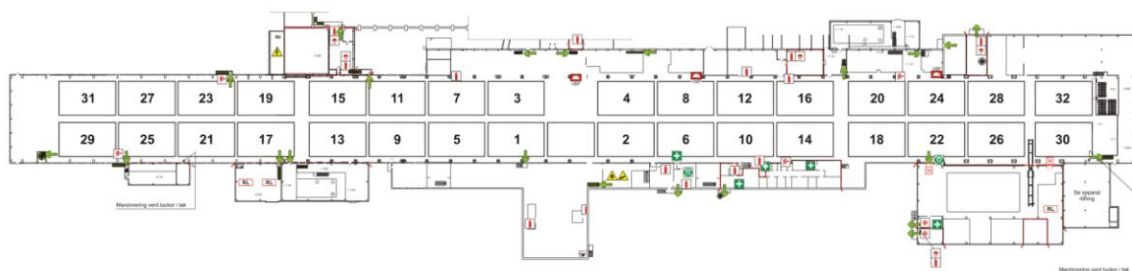
Figur 3: Elektrolysverkets plan +7,1 med 32 grupper av bassänger, byggnaden var 368 meter lång, 28 meter bred och hade en takhöjd på ca 10 meter.
