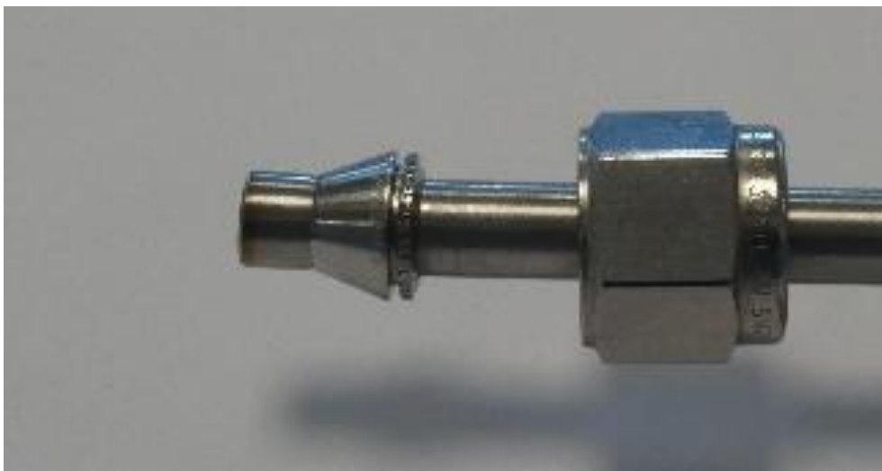
Figur 19: Muttern och konorna på den andra röränden. Denna rörände bedöms i allt väsentligt ha varit korrekt monterad i en T-koppling till annan gasflaska och har demonterats efter olyckan.
