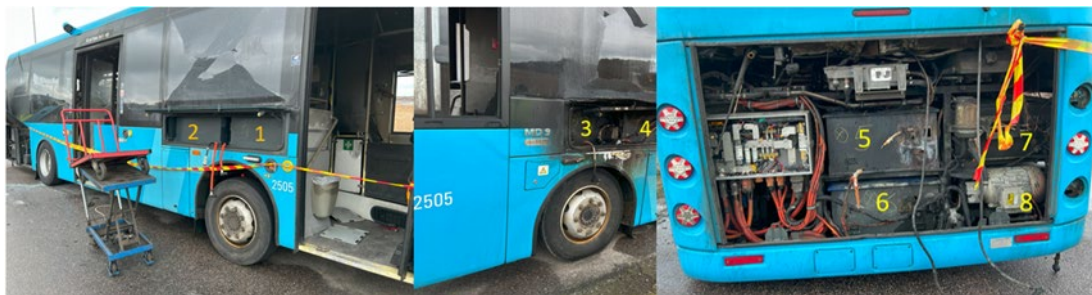
Figur 4 visar batteriernas placering i fordonet, numrerade av räddningsledaren tagna från busstillverkarens instruktion. Källa Räddningstjänsten Öckerö
