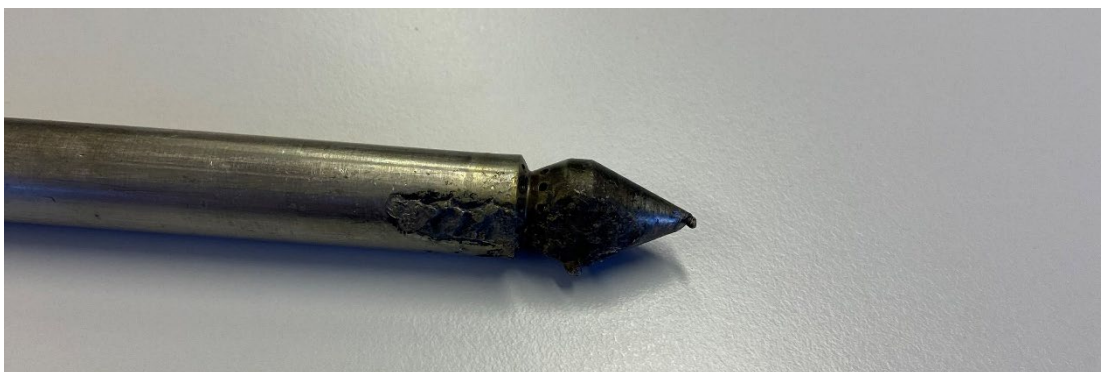
Figur 6 visar den använda dimspikens som på toppen har något som liknar en svetsloppa och andra märken som kan liknas vid brännmärken efter hög temperatur. Denna loppa uppstod troligtvis någon gång under senare delen av första kvällen eller natten, okänt exakt när. Källa Öckerö räddningstjänst
