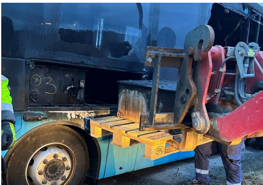
Figur 5 visar när ett av bussens batteripack avlägsnas. Källa Öckerö räddningstjänst
