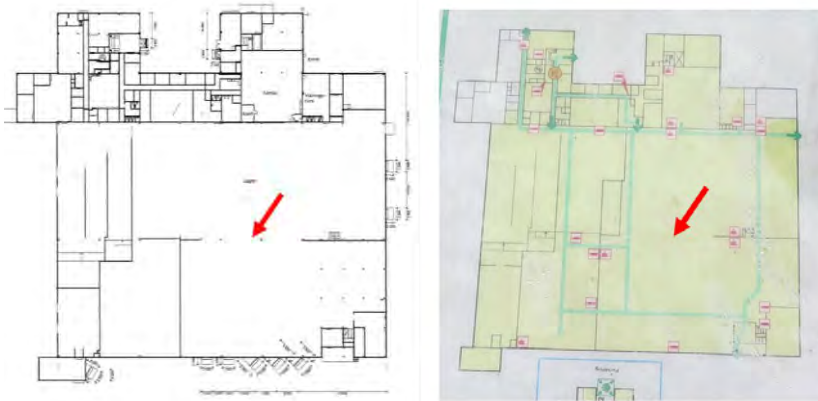
Figur 14 – Utifrån bygglovshandling (t.v.) från tillbyggnadsärende 2013 stod södra och norra lokalen i östra delen av industridelen då i öppen förbindelse med varandra. Det är tänkbart att dessa nyttjades som gemensam lokal vid tillfället. Detta styrks även av äldre utrymningsplan (t.h.) som observeras vid platsundersökning.
