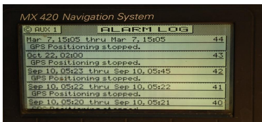
Figur 11. Foto av larmloggen på Leica MX 420 GPS-mottagaren. Bilden är tagen ombord två dagar efter händelsen.
