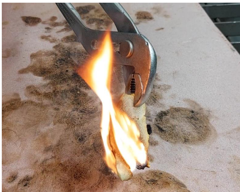
Figur 8. Fogsikummet var lätt att antända och lågan underhölls tills allt skum var borta.
