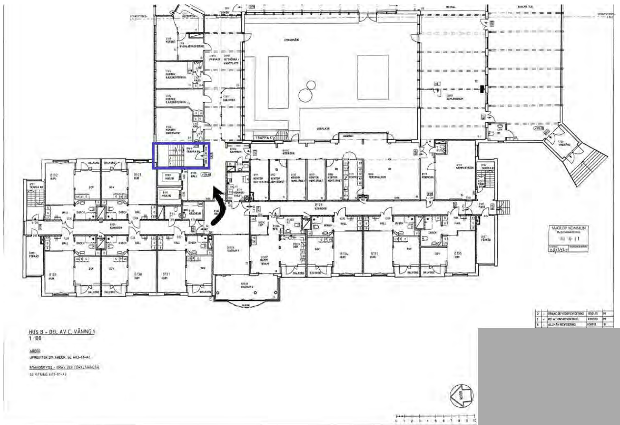
Bild 17: Blå rektangel markerar trapphuset. På grund av en uppställd dörr läckte en viss mängd rök ut ifrån samlingsrummet till utrymmet som angränsande till trapphuset (svart pil).
