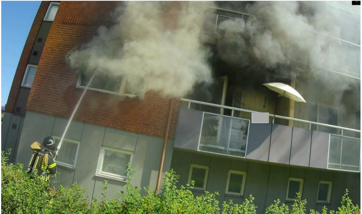
Bild 7: Slutna stråle efter max 10 sekunder. Lågor ej längre synliga och rökgasproduktion har minskat.
