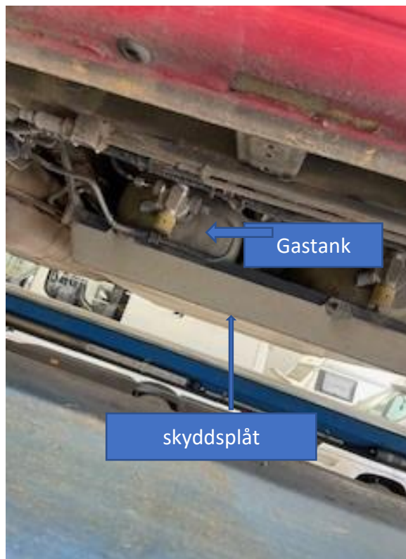
Figur 3 Uppsättning efter ombyggnation ( Foto RTSO)
