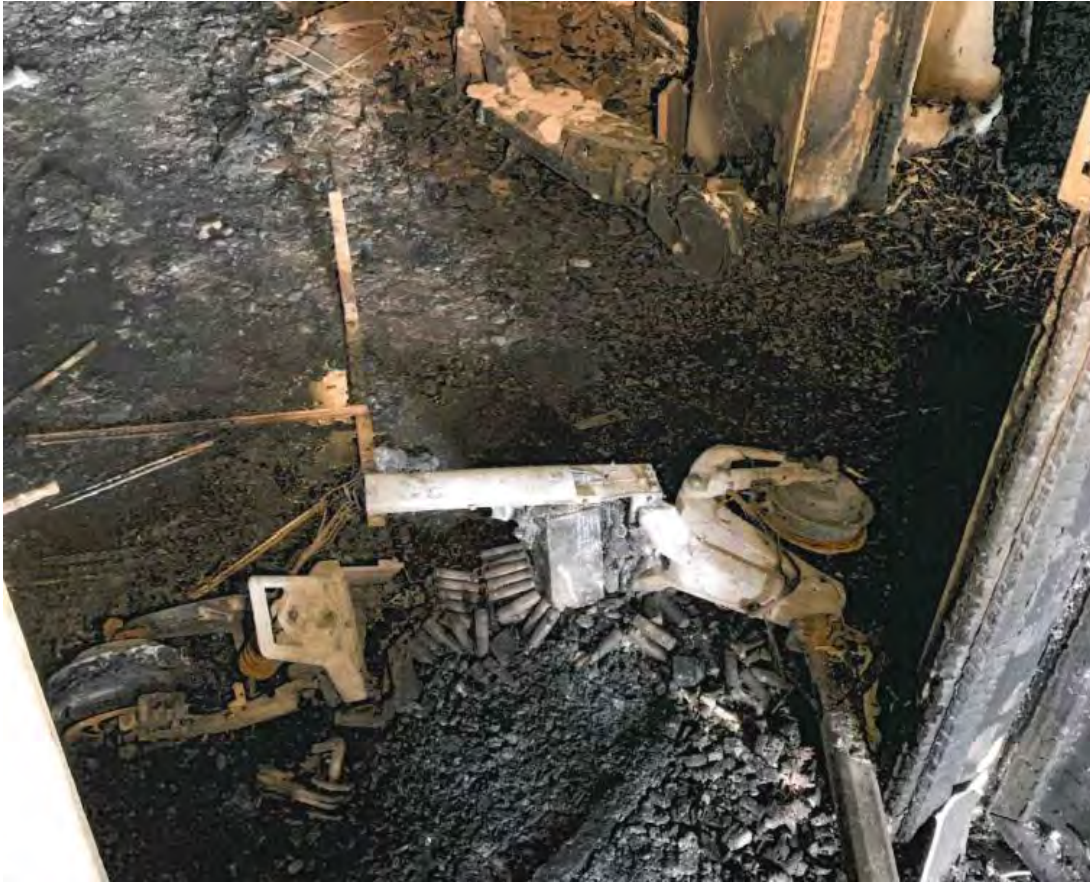
Figur 12. Bild på elsparkcyklarna i lägenhetens hall. Elsparkcykeln närmast i bild hade tydliga skador som pekar på termisk rusning i batteri.
