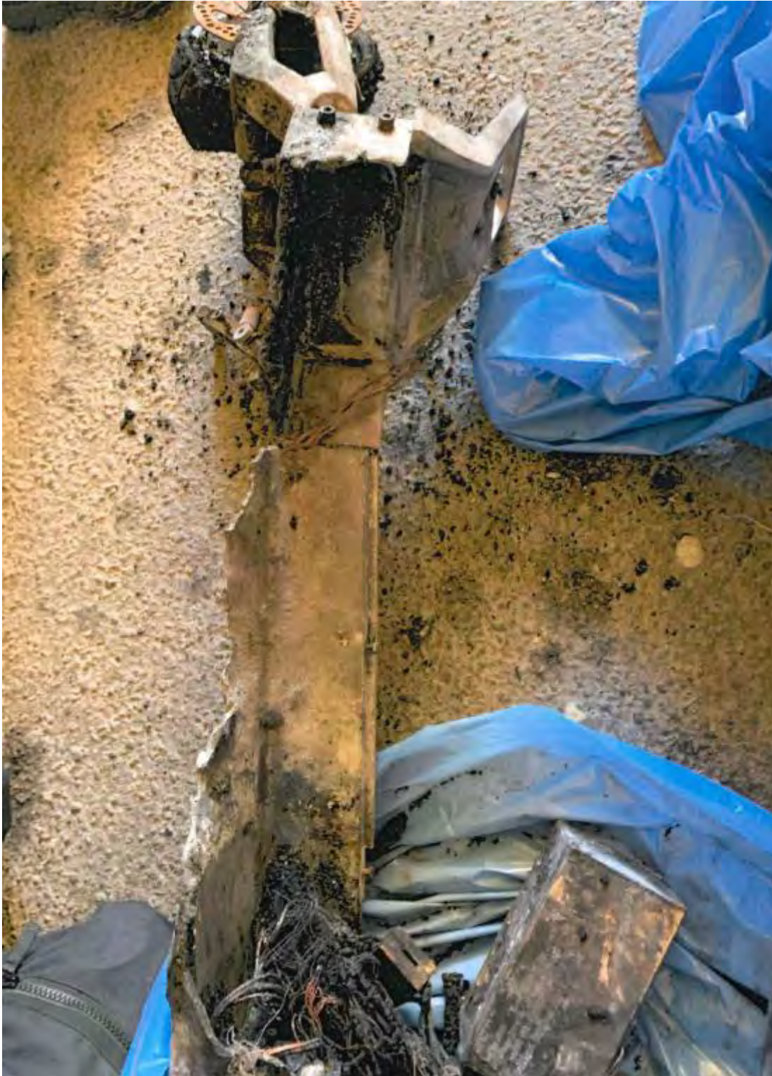
Figur 28. Närbild på elsparkcykeln där skador visar tydliga på intern värmeutveckling/termisk rusning och där battericellerna inuti "tryckts ut". Bilden är från Polisens tekniska undersökning.
