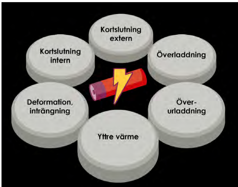
Figur 29. Orsaker till termisk rusning i ett litiumjonbatteri.
