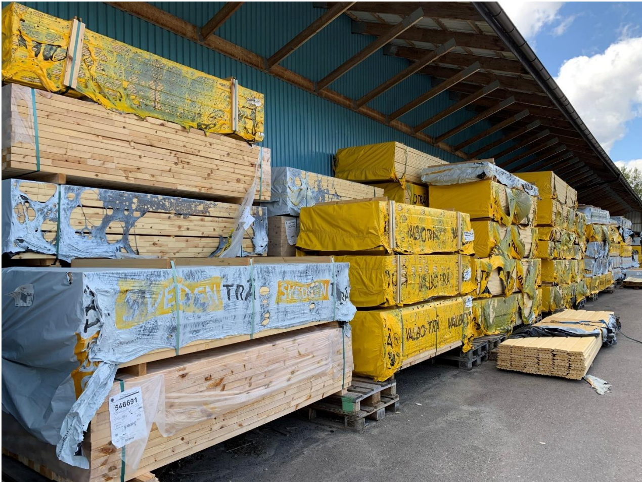
Figur 11 Smält plast på virkespaket av strålningsvärme från byggvaruhuset, foto från brandplatsundersökning 2023-06-08.
