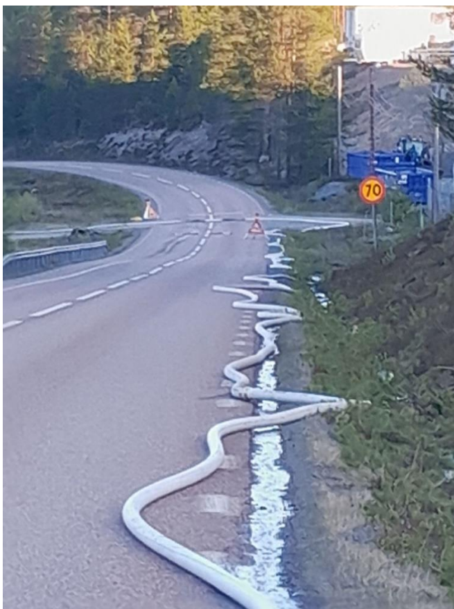
Figur 13 Slangdragning från motorspruta vid badplats, uppskattningsvis har minst 500 meter 76 mm slang krävts.
