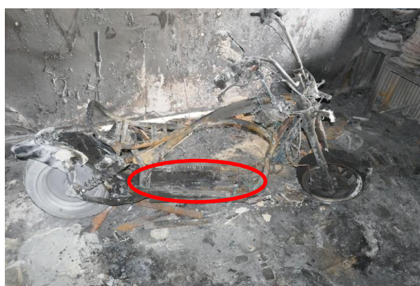
Figur 16 elmopeden när den rests upp. Ringen markerar var batteripacket varit monterat
