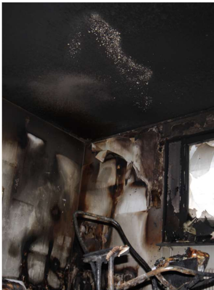
Bild 5, 6 "renbränning" i taket ovanför fåtölj
