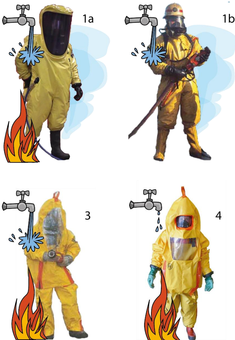
Figur 3.5. Kemskyddsdräkter. Typ 1a – Gastät dräkt med andningsapparaten på insidan av dräkten, Typ 1b – Gastät dräkt med andningsapparaten på utsidan av dräkten, Typ 3 Vätsketät dräkt, Typ 4 Stänktät dräkt. Typ 1a, 3 och 4 kan bäras med branddräkt under och ger på så vis även skydd mot värmestrålning. (OBS att 1b-dräkten på bilden ovan måste kompletteras med en så kallad minihood eller ett översköjningskydd för att den ska vara certifierad som en 1b-dräkt).
