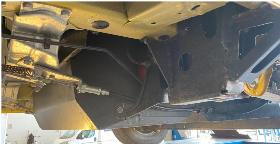
Bild 16 Visar hur skyddsplåt för gastankar på buss i original utförande ser ut
