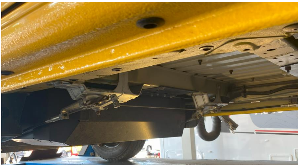
Bild17 Visar hur skyddsplåt för gastankar på buss i original utförande ser ut.
