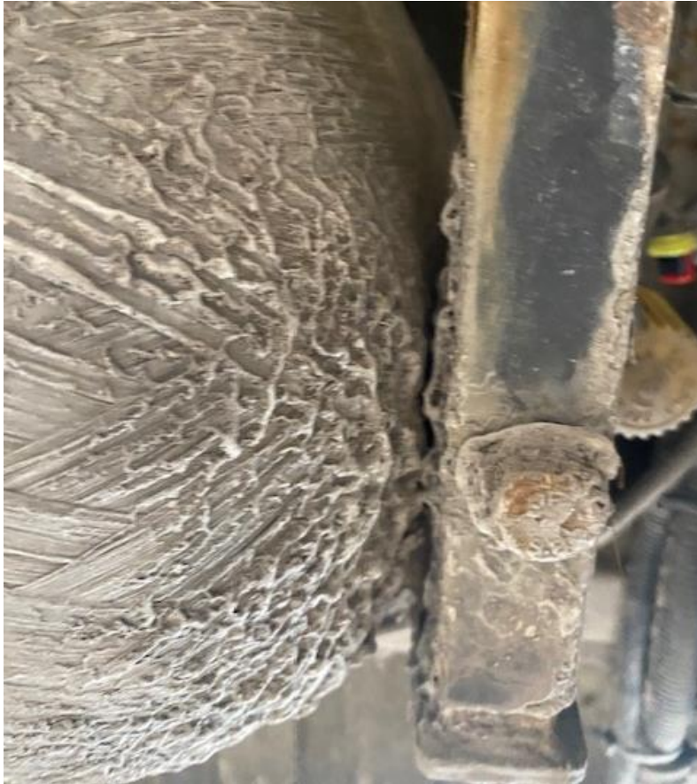
Bild 19 Ansamling av smuts/damm på bakre gastank nummer fem
