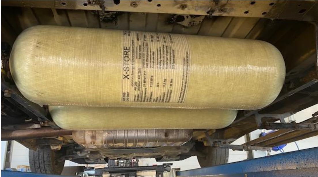
Bild 4 Ombyggd buss, främre komposittankar, skyddsplåt bortmonterad.
