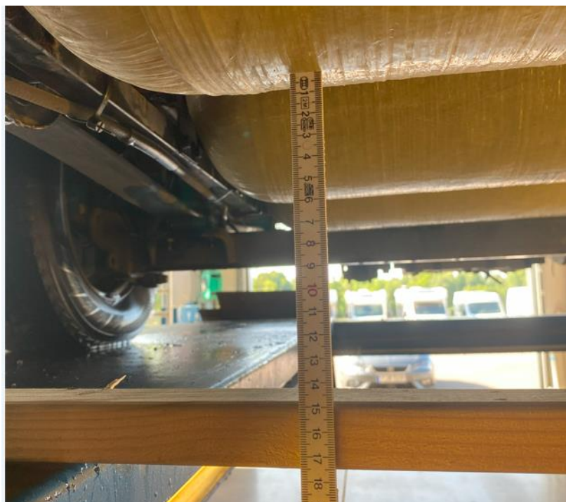
Bild 14 Mätning lägsta punkt bakre gastank till mark
