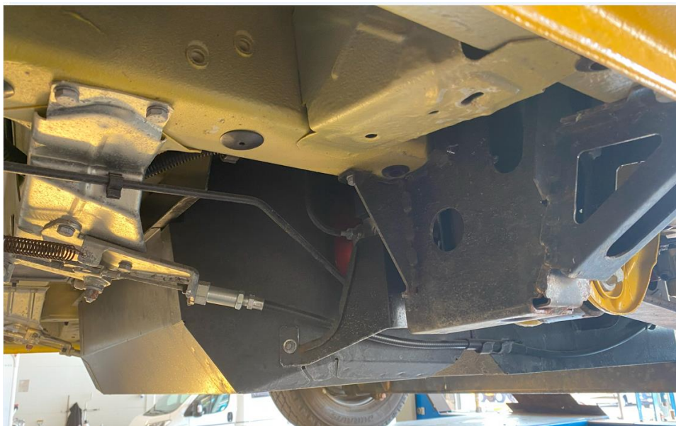
Bild 1 Originalbuss med ståltankar innan ombyggnad.
