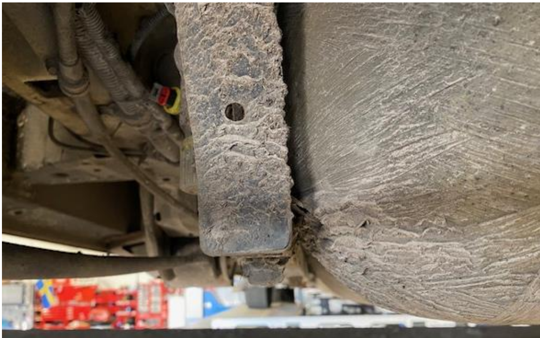
Bild 20 Ansamling av smuts/damm på bakre gastank nummer fem
