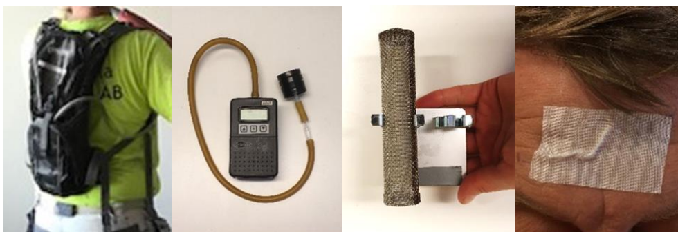
Figur 2. (a) Ryggsäck i vilken mätutrustningen bars under mätdagarna (b) Provtagningsutrustning för traditionell luftprovtagning av PAH (c) En passiv provtagare (en provtagare som inte är kopplad till någon pump) (d) Exempel på tejpning i pannan.
