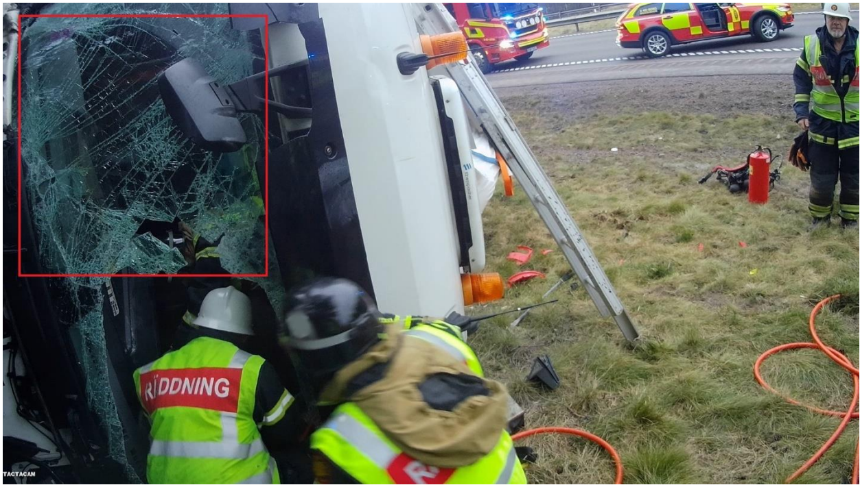
Bild 6: Sågar man upp hela vindrutan (även delen markerad med röd rektangel) vinnns tid i förbättrad arbetsyta.
