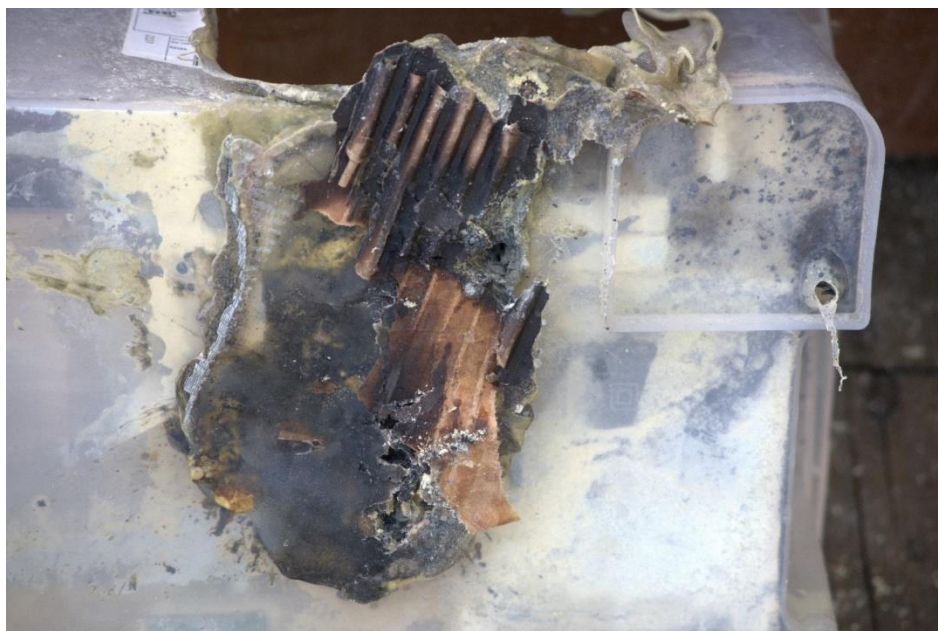
Bild 1. Underdelen på plastlådan hade smält på grund av branden.
