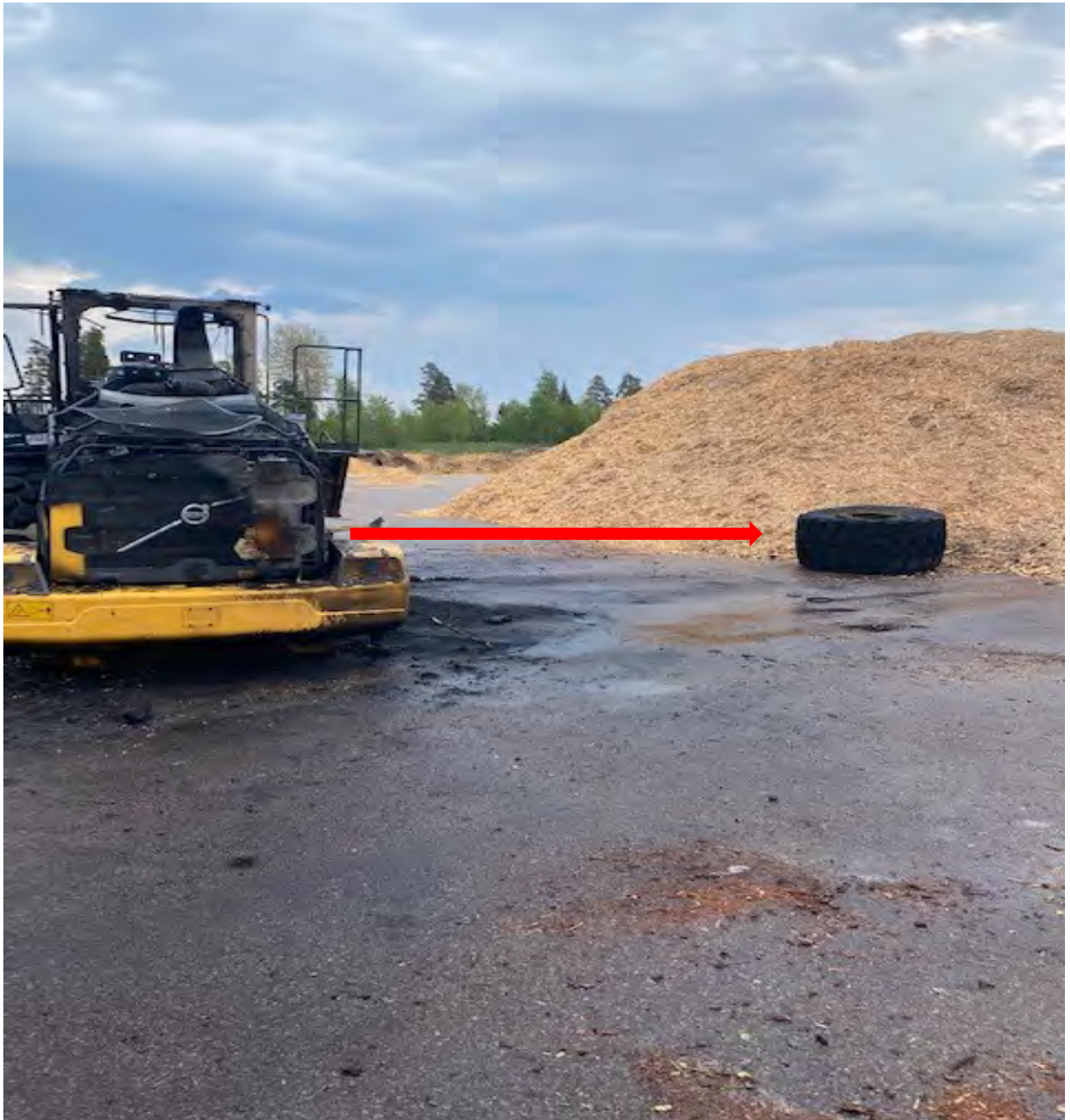
Däck och fälg landar i flishög 12 meter från den brinnande hjullastaren.
