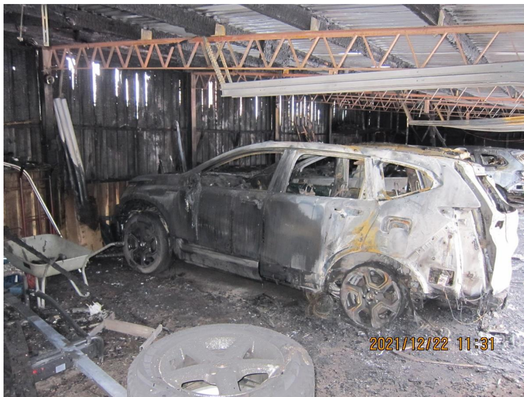
Bild 7: Vy taget mot [redacted] plats [redacted]. Notera främre vänster framhjul har en mindre påverkan av branden, likaså väggens nedre del.
