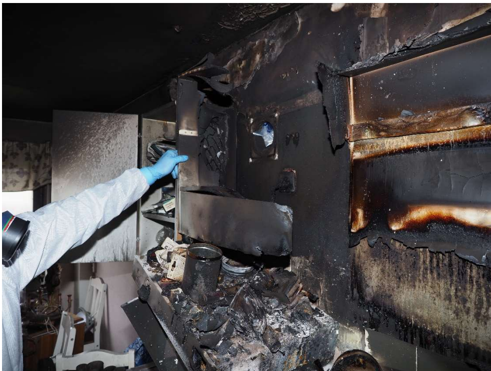
Bild 13: Brandskadorna på kryddhyllan är som förväntat kraftigare upptill än nedtill.
