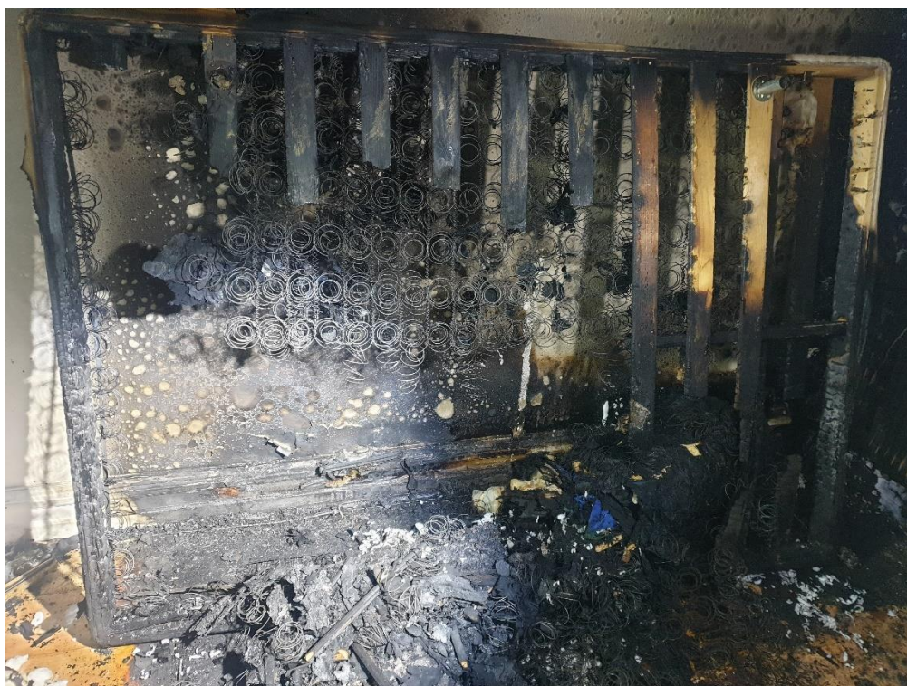
Bild 4 – Sängen i uppställt läge visar tydligt var spjälorna brunnit mest
