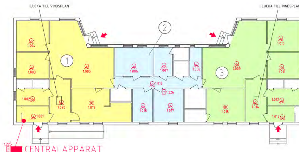
Bild 2 Ritning på förskolans brandlarmsinstallation. Observera att ritningen är vänd i förhållande till karta
