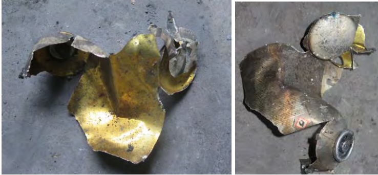
Figur 26 – Uppfläkt aerosolbehållare (sprayparfym) påträffas i hopsamlade brandresterna i sovrummet vid platsbesök.
