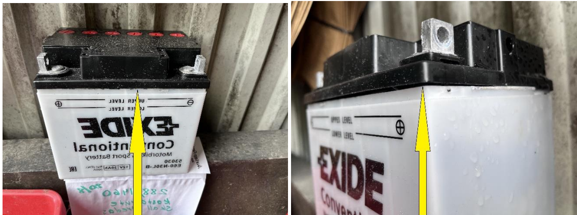
Figur 4. Batteriet där överdelen lossnade av explosionen.
