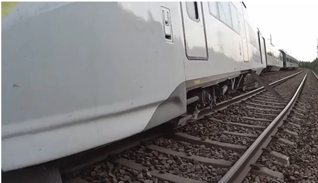
Figur 12 Sista vagnen står över spåren och blockerar södergående trafik.
