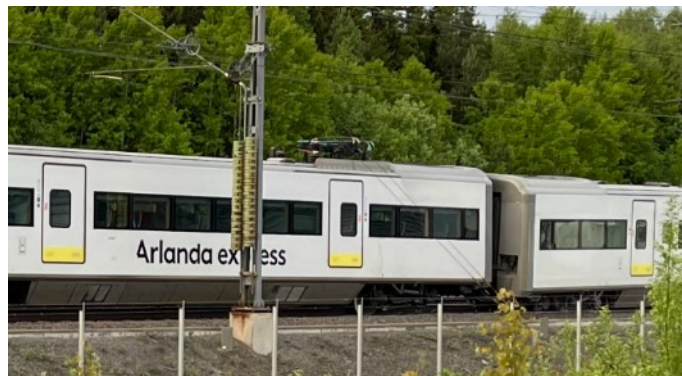
Figur 17 Strömavtagaren nerfälld, hjulen på vagnen står kvar på rälsen, kontaktledningen och stolpar intakta.
