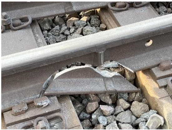
Figur 15 Krafterna från urspårningen knäckte och böjde rälsen på flera ställen, vissa helt av och andra med tydliga skador.
