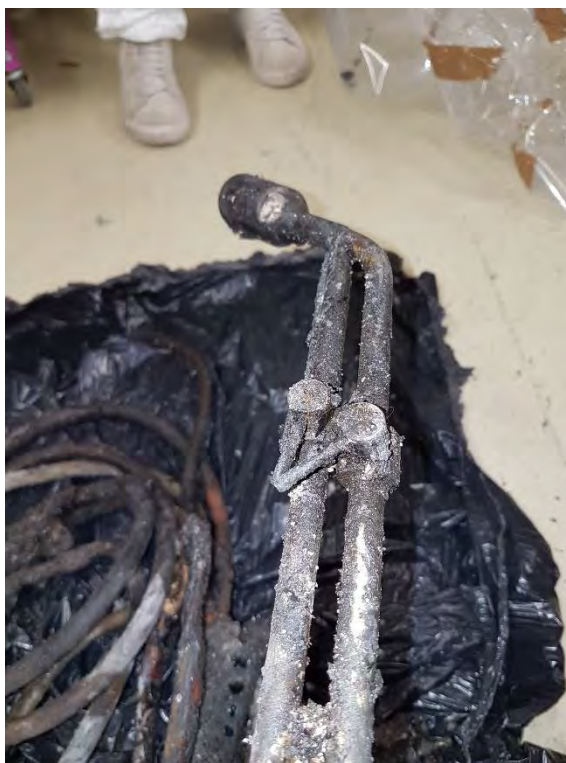
Figur 10 Gasolmunstycke och gasolslangar
