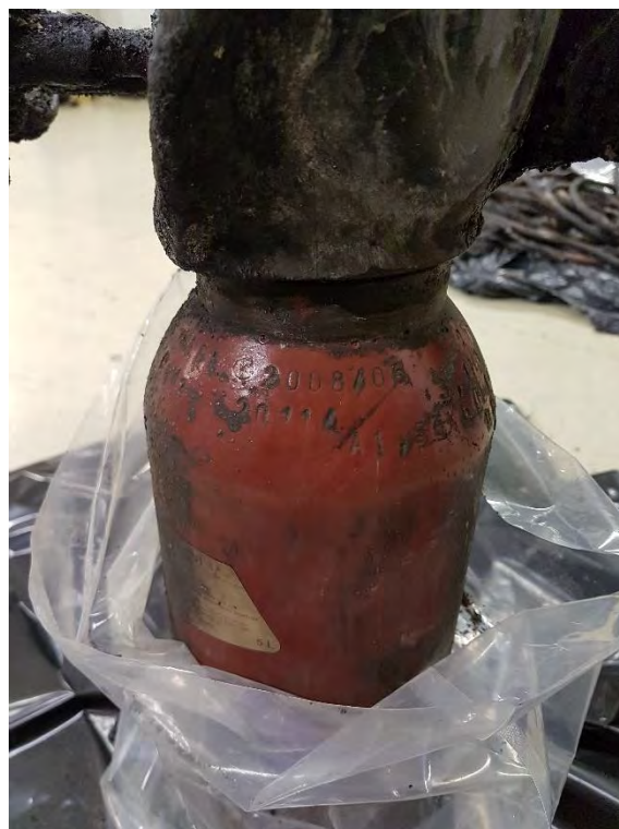
Figur 12 Märkning provtryckning - Acetylenflaska
