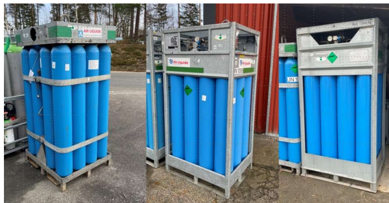
Figur 1: Typiskt transportabelt flaskpaket för industrigaser
