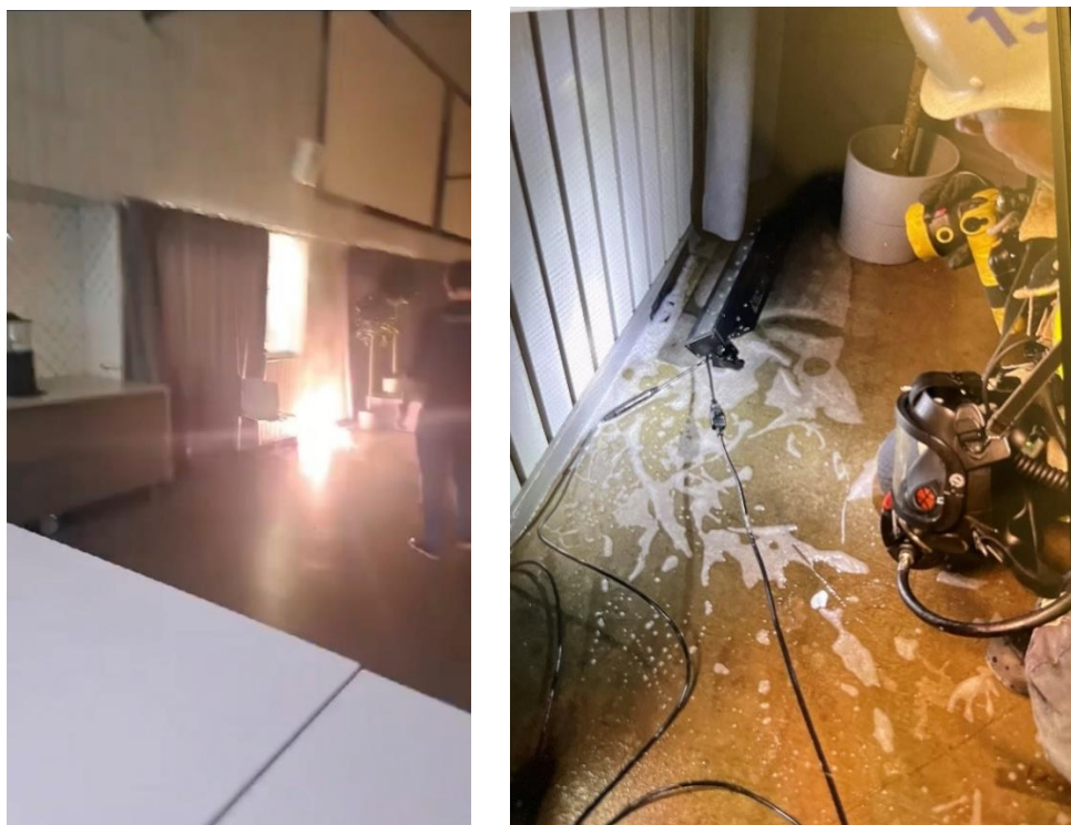
Figur 4. Bild tv visar brandutvecklingen efter det första släckförsöket då branden visar sig fortgå. Bild th visar ljusrampen efter att den är släckt. Bild tv. Skärmdump från film tagen av personalen vid brandtillfället 2023-09-15. Bild th. Tagen av insatspersonal 2023-09-15.
