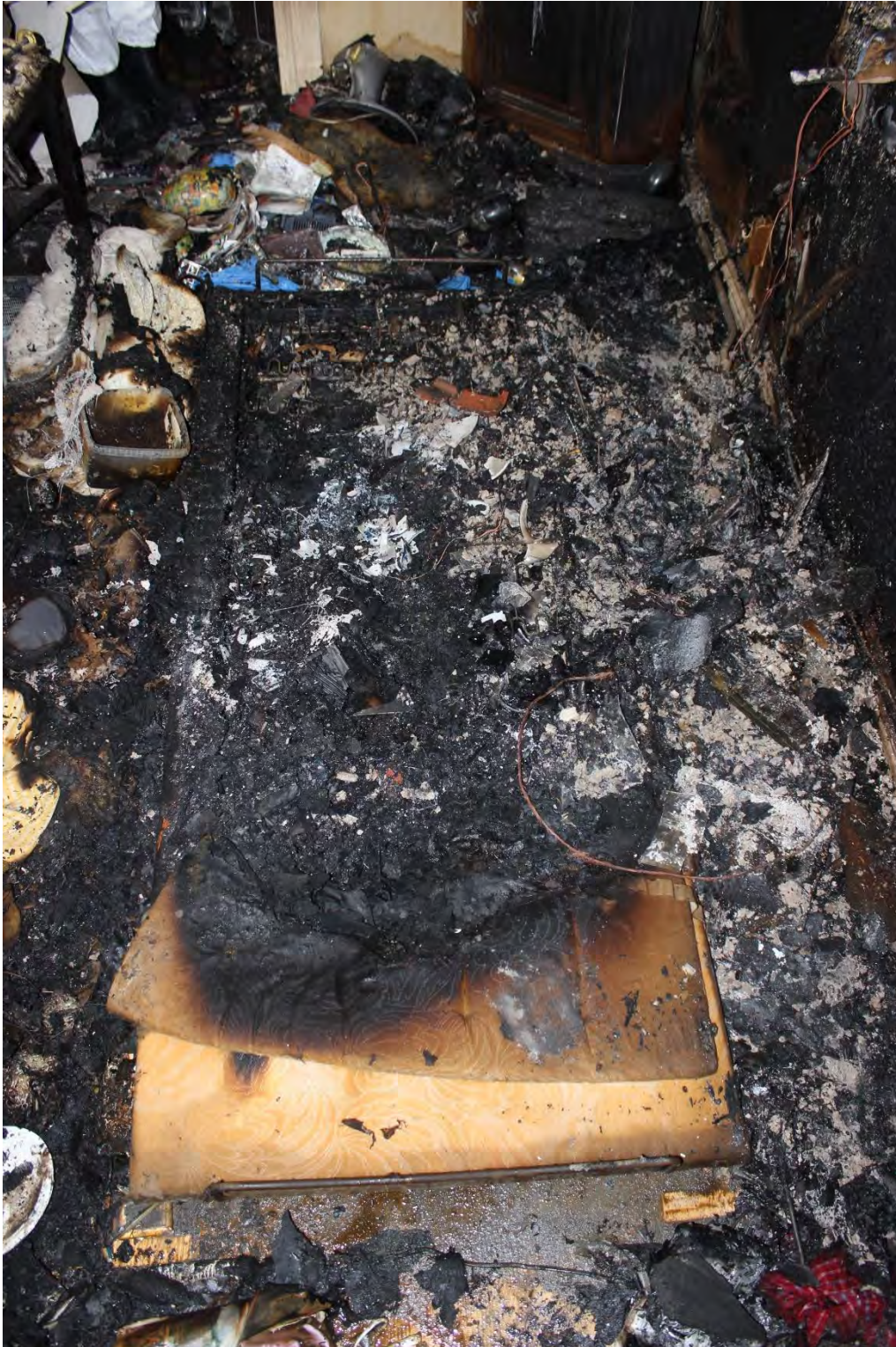
Figur 8. Bild på brandresterna av bäddsoffan från en annan vinkel.
