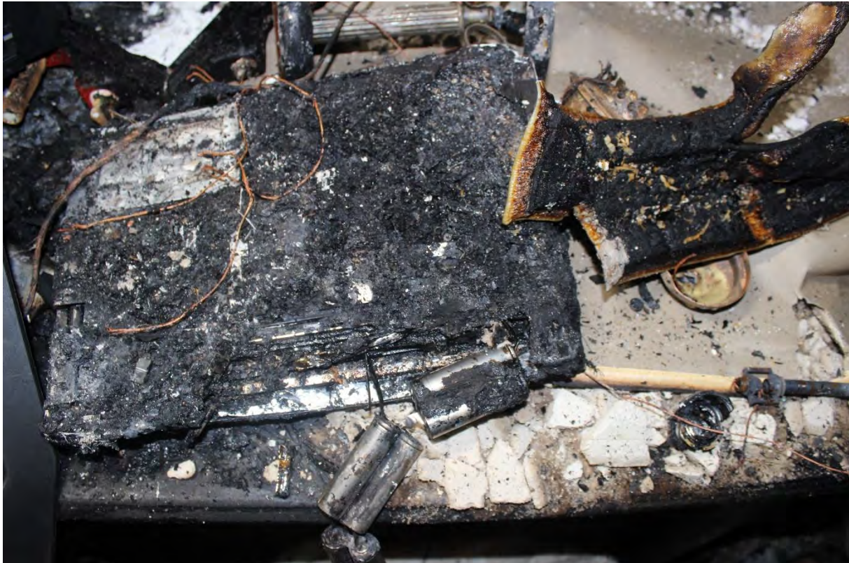
Figur 9. Bild på bärbar dator som återfanns bland resterna. Batterierna är intakta.
