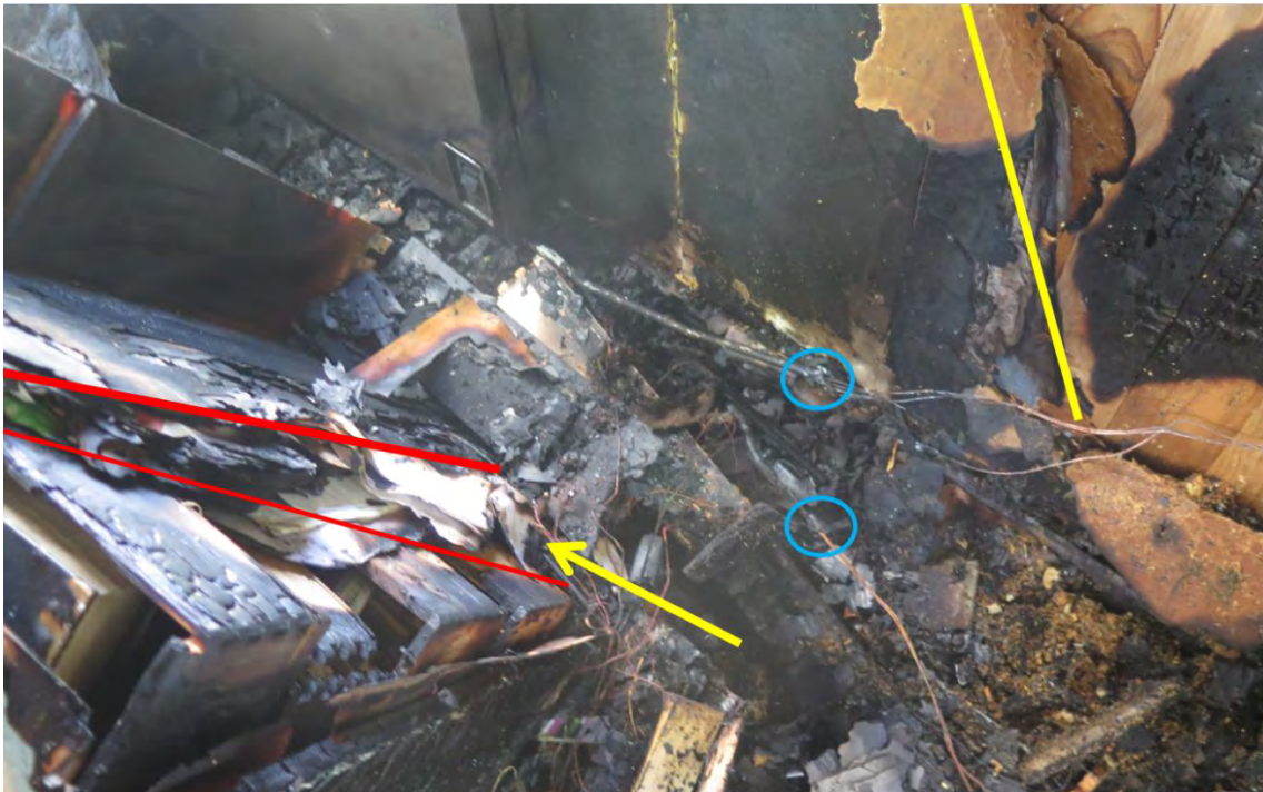
Figur 8 - Avtagande skador baksida skrivbord. Skrivbord har stått placerad mot gavelsidan av sovrummet till höger om fönster i denna gavel och sett inifrån rummet (se figur 4). Kraftig brandpåverkan bedöms ha skett i den gula pilens riktning (från hörnet). Notera att kablar som löper in i området är renbrända inom området (blå markering).
