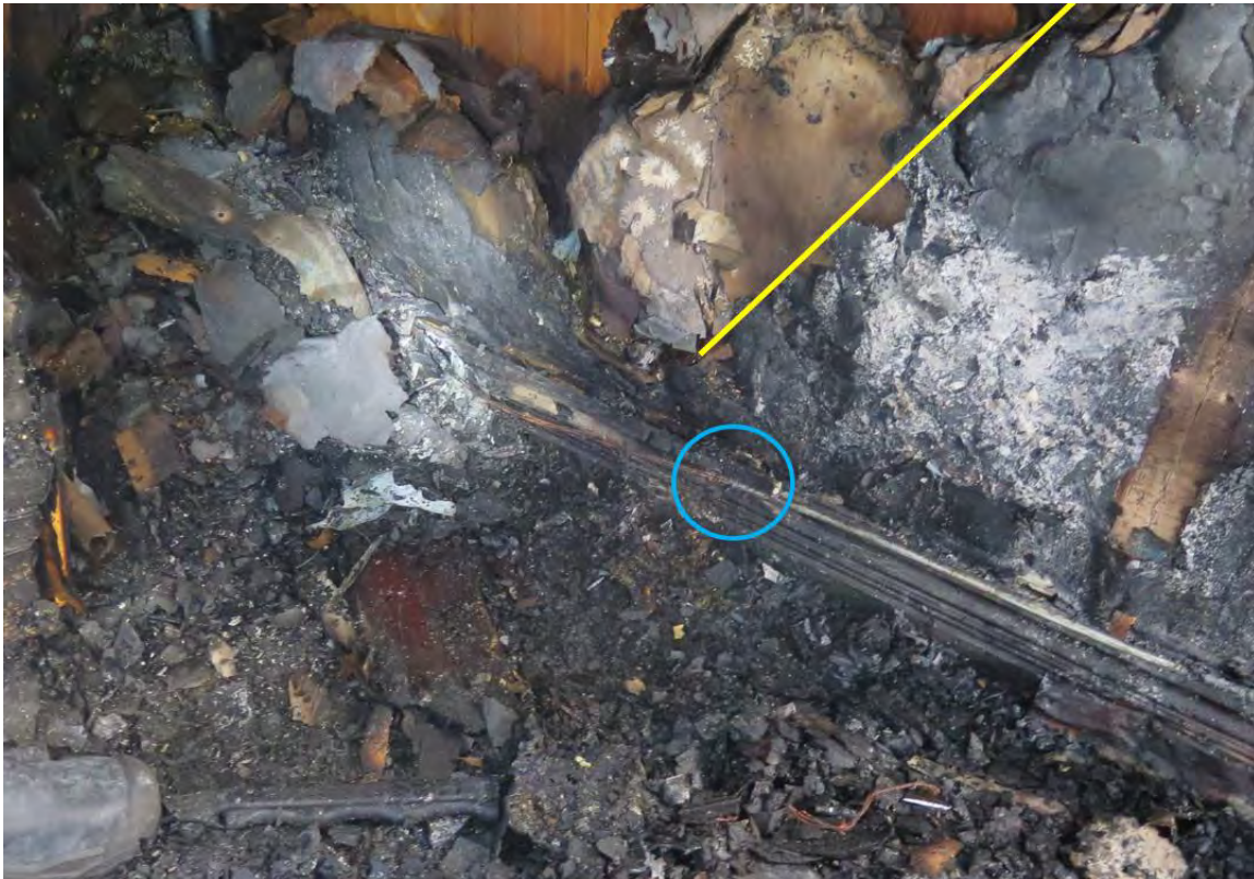
Figur 9 - Motsvarande mönster som enligt figur 8 finns även på gatusida av sovrummet. Lågt placerade kablar är avbrända inom området (skador avtagande bort från hörnet).
