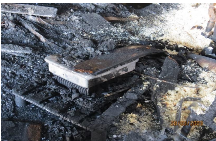
Bild 4: Bilden visar växelriktaren som var levererad men inte inkopplad, den låg på en pall i garaget.
