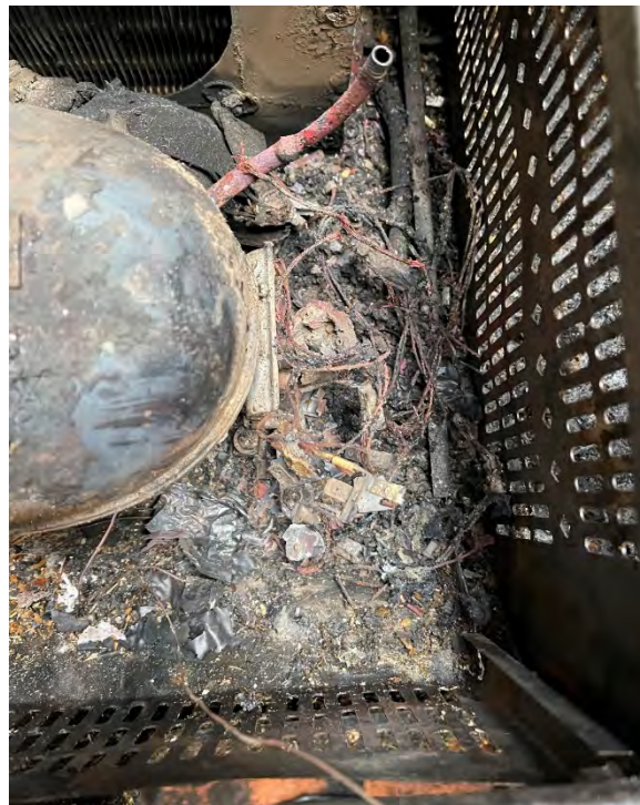
Bild på nersmält styrenhet till kompressorn
