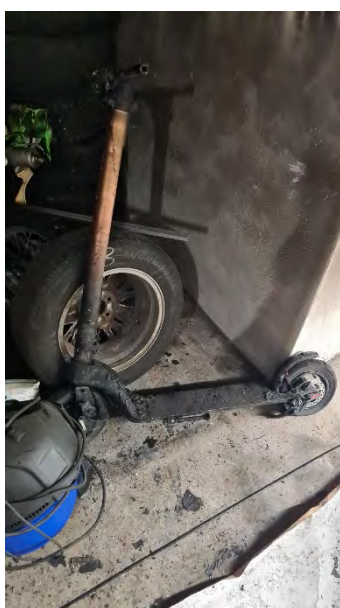
Bild 1: Elsparkcykeln som troligtvis orsakade branden, på denna bild har elsparkcykeln flyttas.
