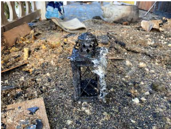
Bild 4: visar ljuslyktan och det fastsmälta delarna av plastbordet.
