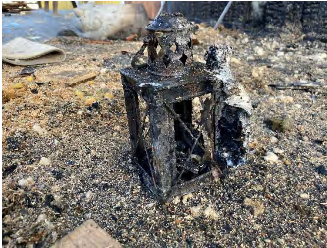
Bild 3: visar ljuslyktan och det fastsmälta delarna av plastbordet.
