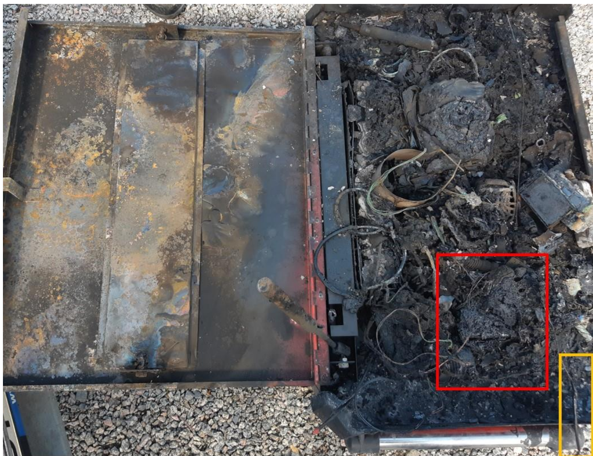
Bild 5. Rött område visar pannlampa med batteripack. Orange område visar sladd från laddare.
