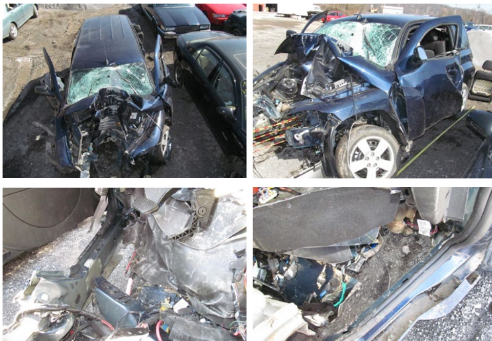
Figur 25. En 2011 Chevrolet HHR med ursprungshastigheten 114 km/h kör in en stolpe. Hastighetsförändringen i x-led var 95 km/h, i y-led 23 km/h. Rivning av svetsförband mellan tröskel och golv på bägge sidor. Både föraren och passageraren fram var obältade, föraren omkom men inte passageraren.
