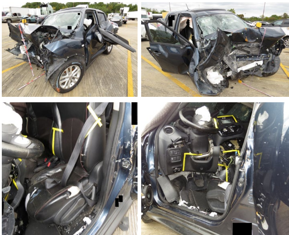
Figur 26. En 2013 Nissan Juke kör in i ett betongfundament med ursprungshastigheten 101 km/h. Hastighetsförändringen i x-led 98 km/h, y-led 18 km/h. Denna krock är mycket likt ett krockprov i barriär varför nästan all ursprungshastighet omsattes till \Delta V . Ingen rivning av svetsförband kunde ses. Föraren ådrog sig MAIS 5 men överlevde.
