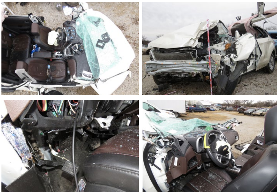
Figur 24. En 2014 Chevrolet Equinox med ursprungshastighet på 115 km/h kör in i ett träd med small overlap. Hastighetsförändringen i x-led var 85 km/h, i y-led 18 km/h. Ingen rivning av svetsförband kunde ses. Den bältade föraren hade MAIS 3 och överlevde.
