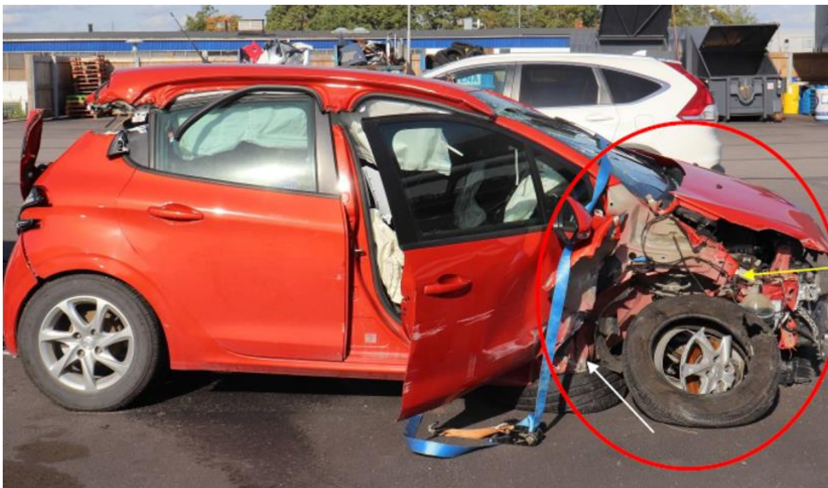
Bild 5. Bil 2. Röd ring visar kollision med broräcke och sidoräcke. Vit pil, sidobalk intryckt ca 150 mm. Gul pil, sidobalk främre som vikt in mot motorutrymme ca 50 mm.
