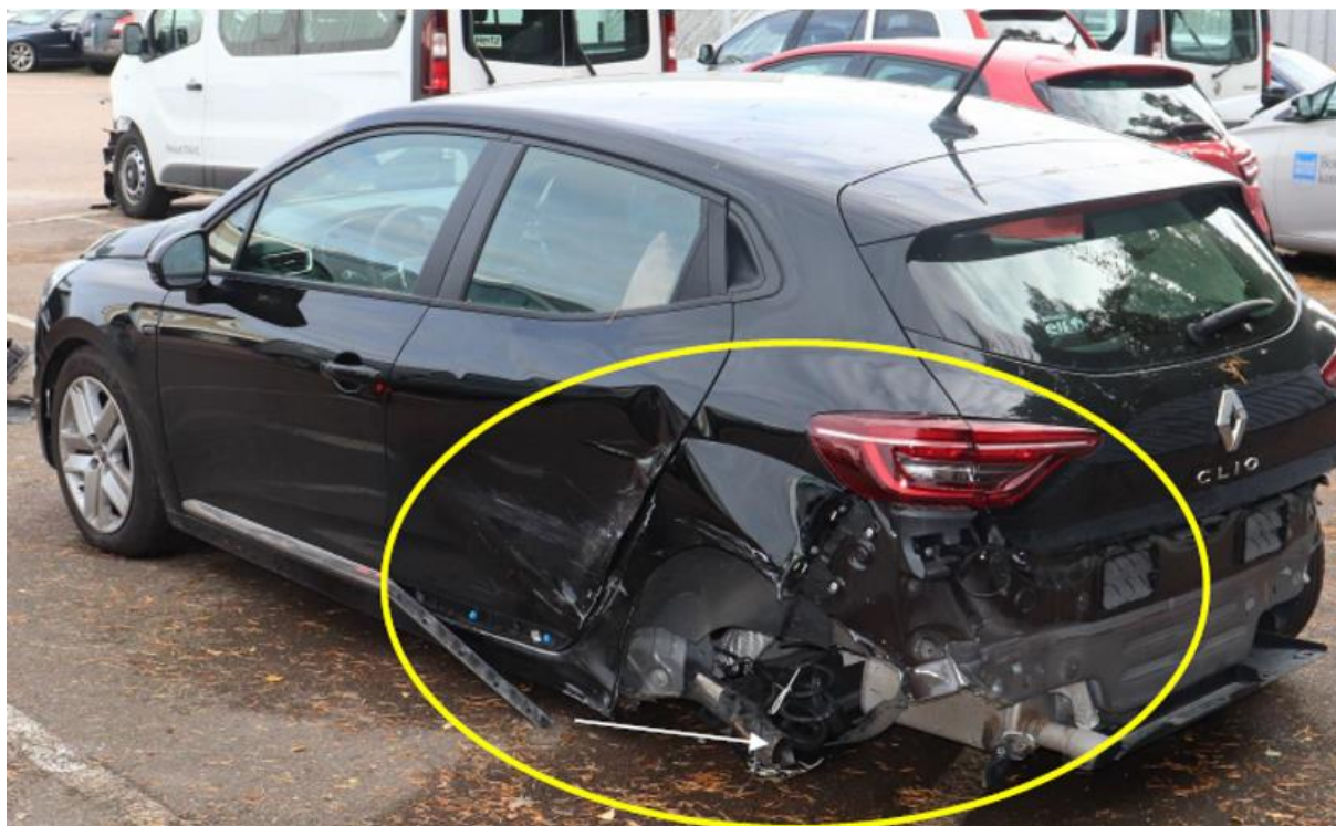
Bild 7. Bil 3. Gult inringat område visar kollision med Bil 1. Vit pil visat mot avslaget fjäderben mot övre delen av hjulhuset samt separation av länkarm mot bakaxel.
