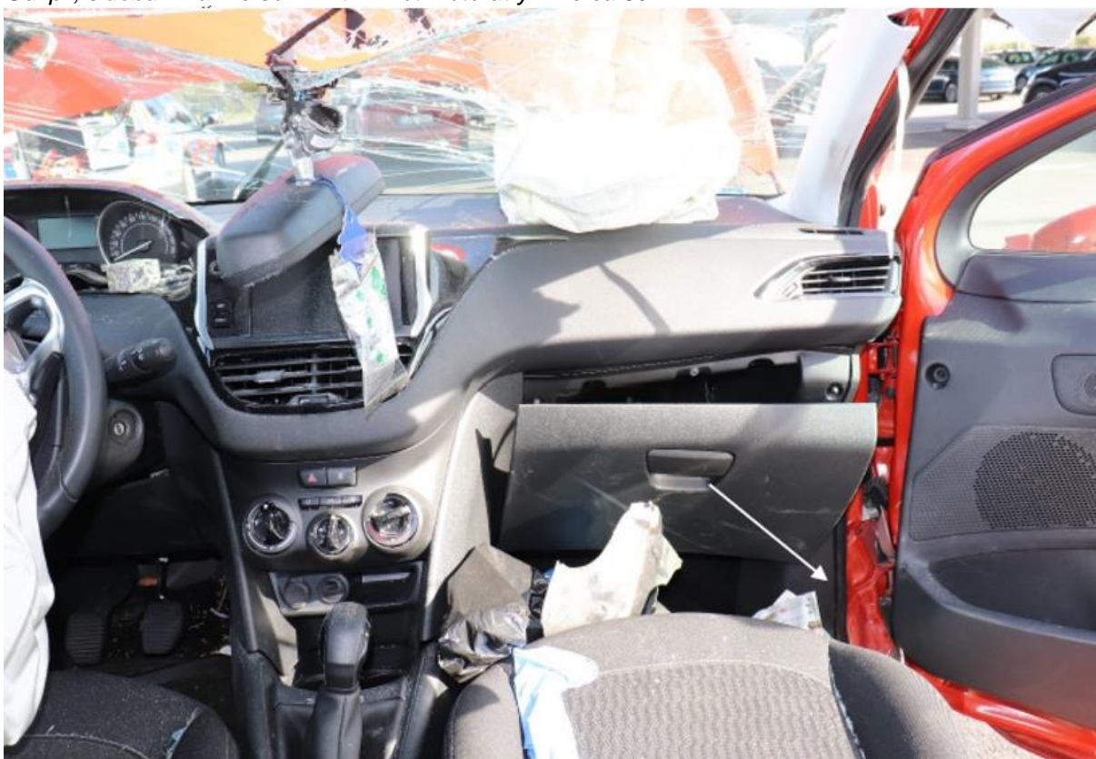
Bild 6. Bil 2. Passagerarplats höger fram. Vit pil visar en mindre inträngning av A-stolpen i fotutrymmet. I övrigt inga islag.
