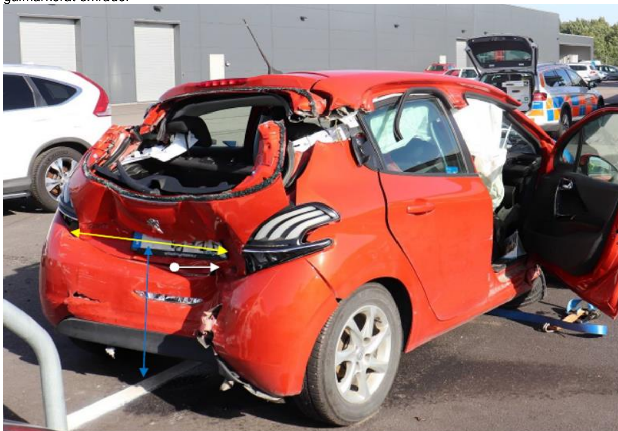
Bild 4. Bil 2 skador efter kollision med Bil . Gul pil är ca 900 mm i bredd. Blå pil 620 mm i höjd. Vit pil intrycksdjup ca 200 mm.
