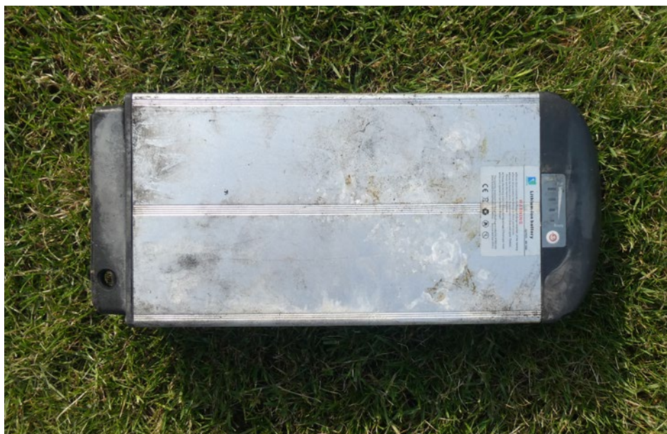
Figur 1. Bild på "tvilling" till det brunna batteriet som legat nära det brunna. Begränsad skada på golvet där det brunna batteriet legat (Foto: Ulf Bergholm, MSB:s olycksutredare).
